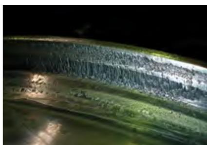
Состояние реборды колеса ДО установки систем смазки (задиры, деформация поверхностного слоя)
