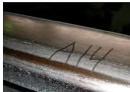
Состояние подкранового пути через полтора года ПОСЛЕ установки систем смазки (равномерное заполнение контактной поверхности смазкой)
