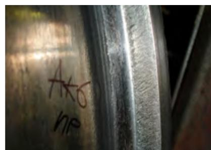
Состояние реборды колеса через полтора года ПОСЛЕ установки систем смазки (поверхность загладилась до металлического блеска, присутствует постоянный слой смазки)
