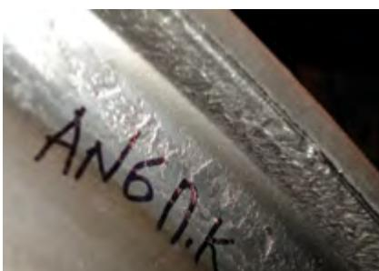
Состояние реборды колеса через четыре месяца ПОСЛЕ установки систем смазки (выравнивание поверхности)
